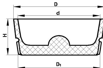
24-1602516 1602 1 1 1 17,5 26 24,5 6,2 Манжета уплотнительная поршня цилиндра выключения сцепления
