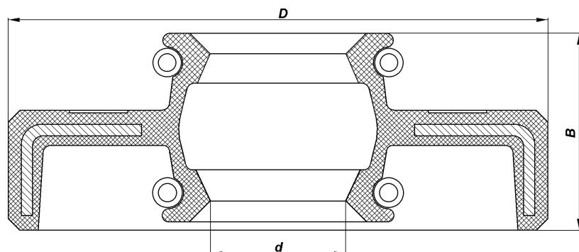
3160-2402052 2302 1 1 1 1 42 72 - 16,4 Манжета уплотнительная переднего и заднего мостов с пружинами в сборе
